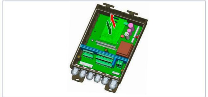
Platzieren Sie die LonWorks Optionskarte vorsichtig über die drei verschiedenen Pin-Steckverbinder des Gehäuseunterteils. Vermeiden Sie jegliches Verbiegen der Pins.
